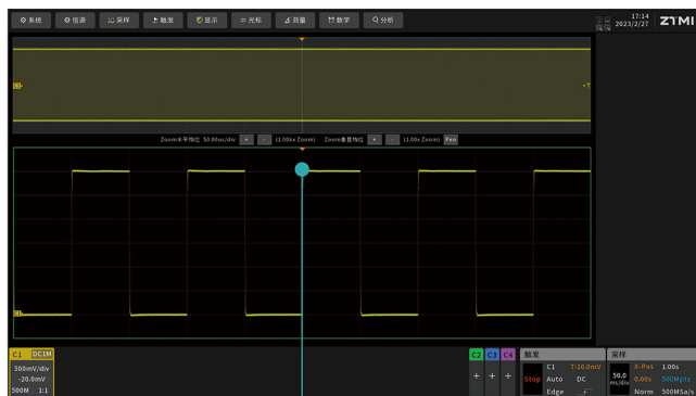
500M存储深度, 捕获1s波形, 采样率依然高达500MHz, 波形完全没有失真
