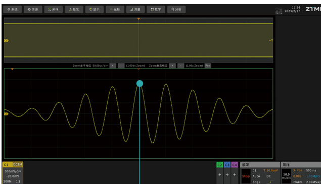
1M存储深度, 捕获500ms波形, 采样率下降至2MHz, 波形已经完全失真
