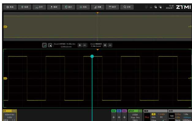
500M存储深度, 捕获1s 波形, 采样率依然高达500MSa/s, 波形完全没有失真
