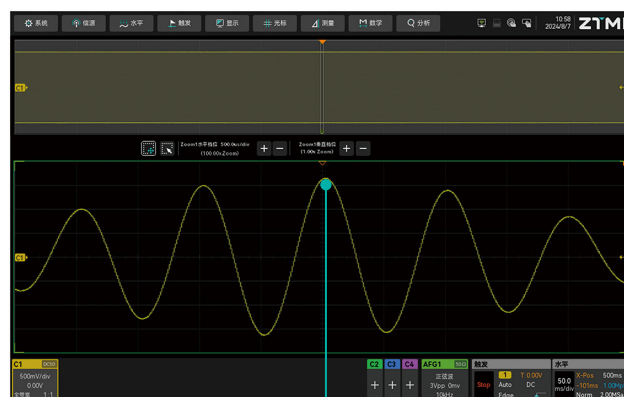
1M存储深度, 捕获500ms 波形, 采样率下降至2MSa/s, 波形已经完全失真
