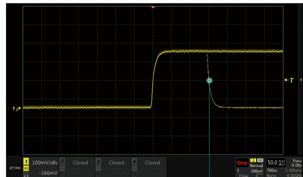
只有高刷新率的示波器，才能刷出低概率的异常信号
