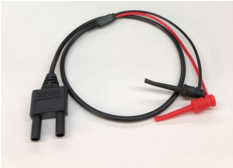
图 3.6 DSO 通道测量线
