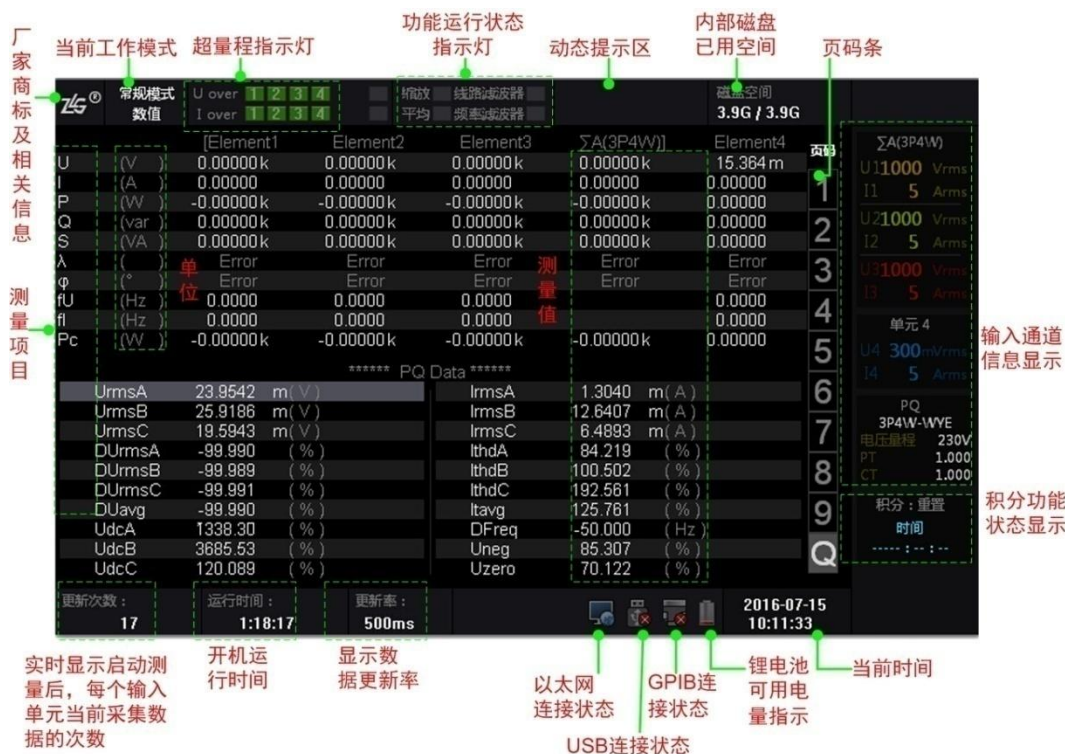
图 3.2 常规测量模式下的屏幕显示实例
