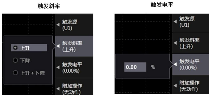
图 5.27 原始数据触发类型下的触发条件
