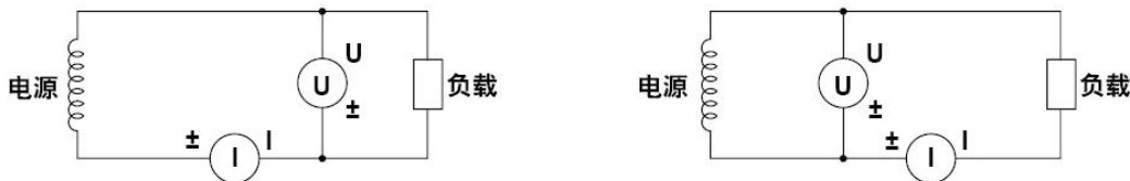
图 4.34 测量电压和电流的大小对测量的影响
