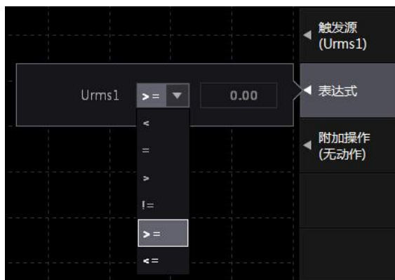
图 5.28 常规数据触发类型下的触发条件
