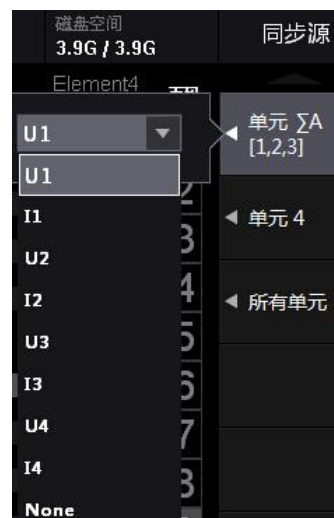
图 4.21 选择须配置同步源的输入单元
