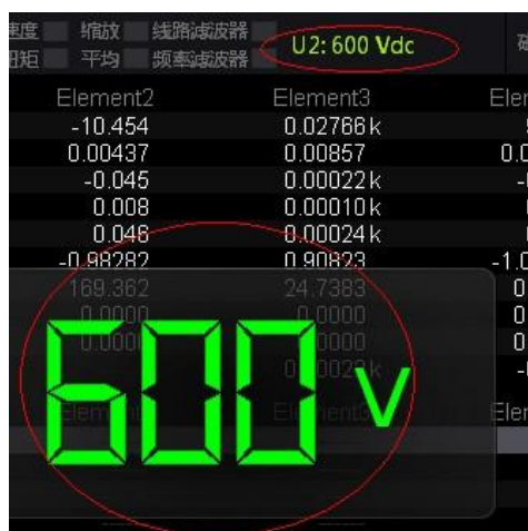
图 4.20 电压量程显示
