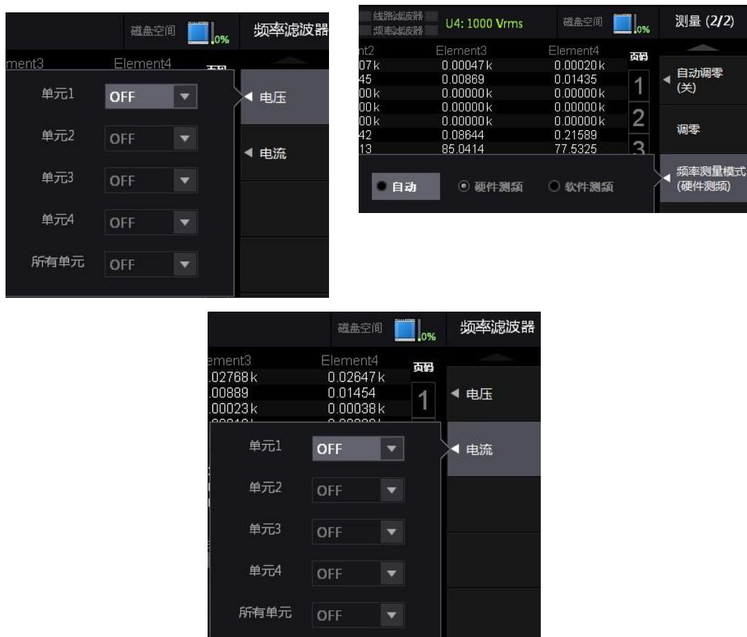
图 4.11 开启/关闭频率滤波器
