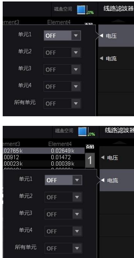
图 4.9 选择须配置线路滤波器的对象单元
