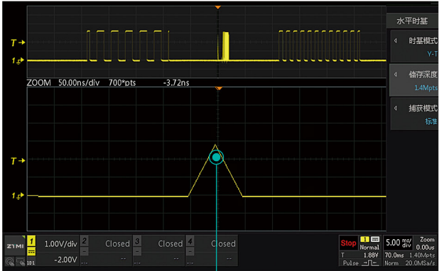
1.4M 存储深度下, 采样率降低到 20M, 波形已经完全失真
