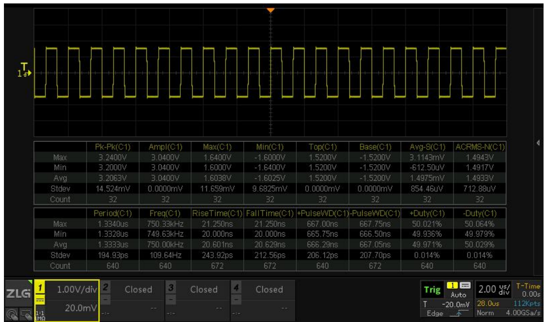
图 12.8 电压+时间综合测量
