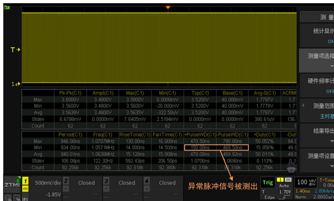
图 12.9 电压+时间综合测量
