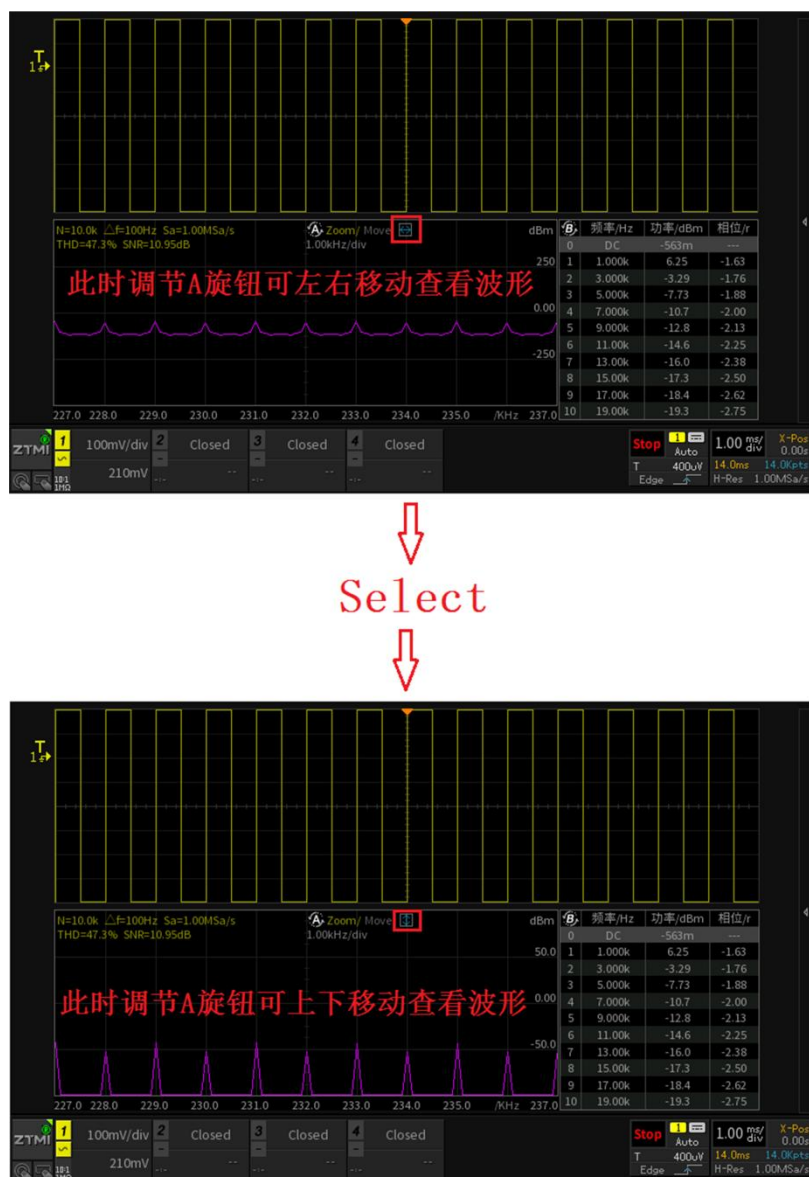
图 18.7 垂直幅值调节和水平频率调节切换
