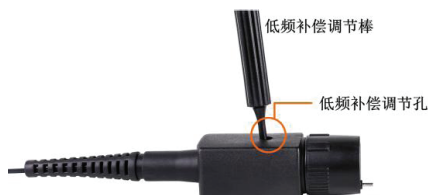
图 5.7 探头补偿调节孔
