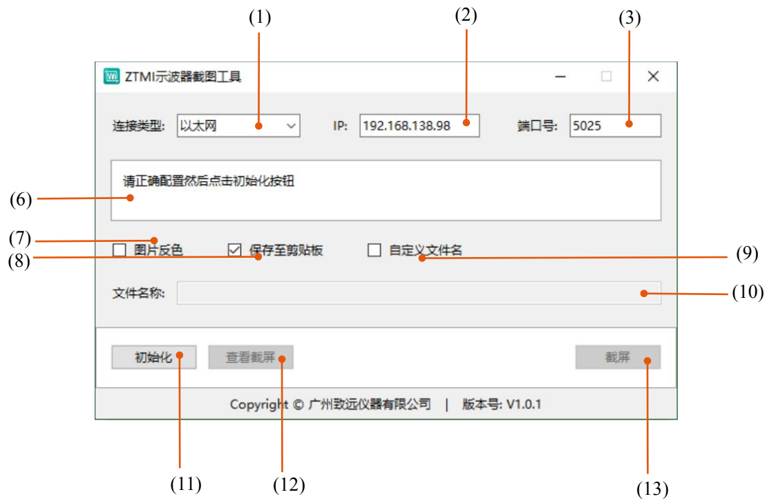
图 2.1 以太网连接界面
