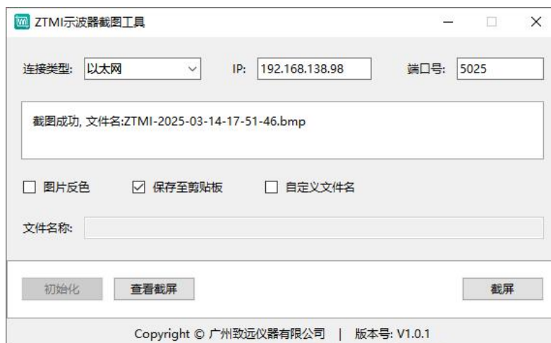
图 2.9 示波器截图软件截图完成
