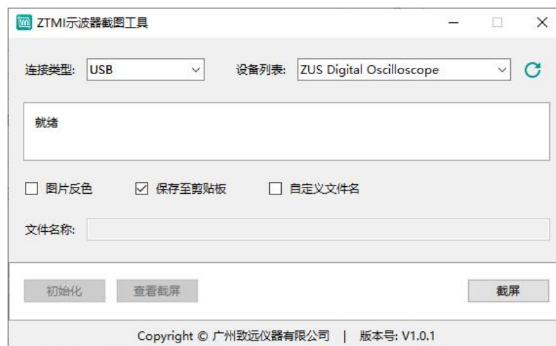
图 2.26 USB 连接初始化
