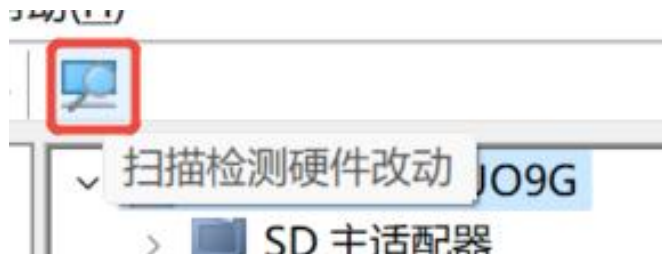
图 2.14 扫描检测硬件改动
