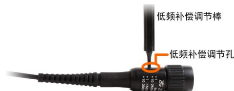
图 5-7 探头补偿调节孔
