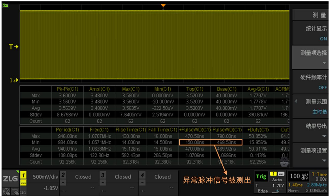
图 12-9 电压+时间综合测量
