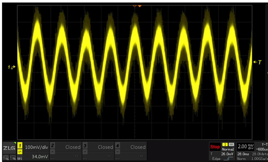
图 17-14 电源芯片输出波形
