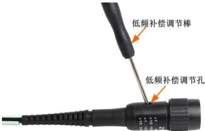
图 5.7 探头补偿调节孔
