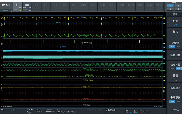
128路波形信号混合测量
