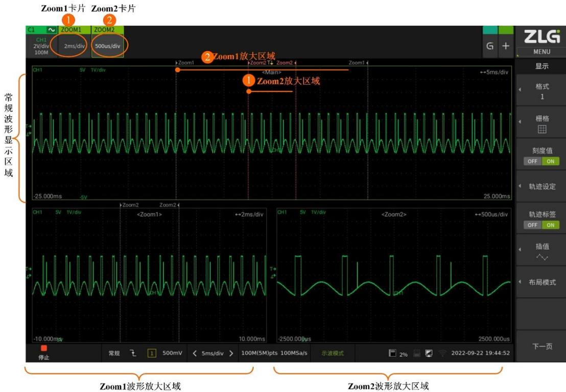
图 3.23 水平方向缩放波形
