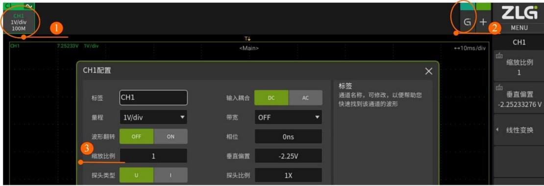
图 3.19 设置波形垂直缩放步骤图
