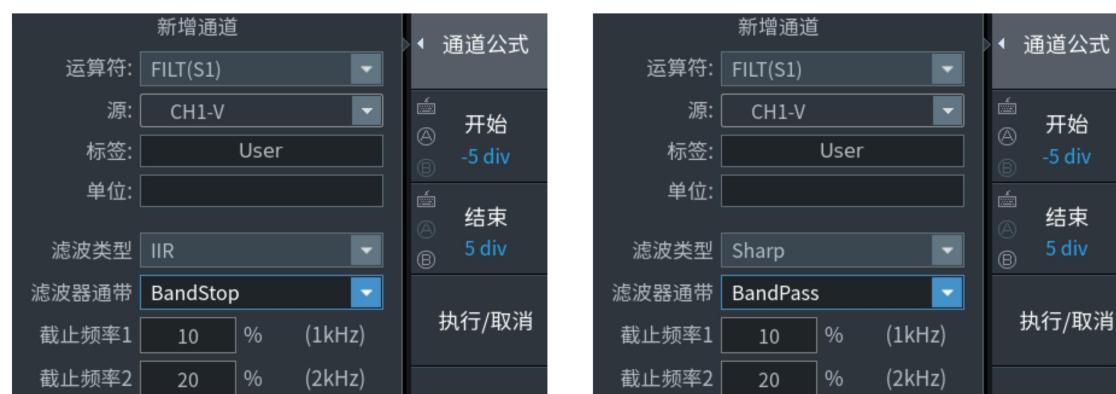
图 5.11 滤波器通带是 BandStop 和 BandPass 截止频率设置
