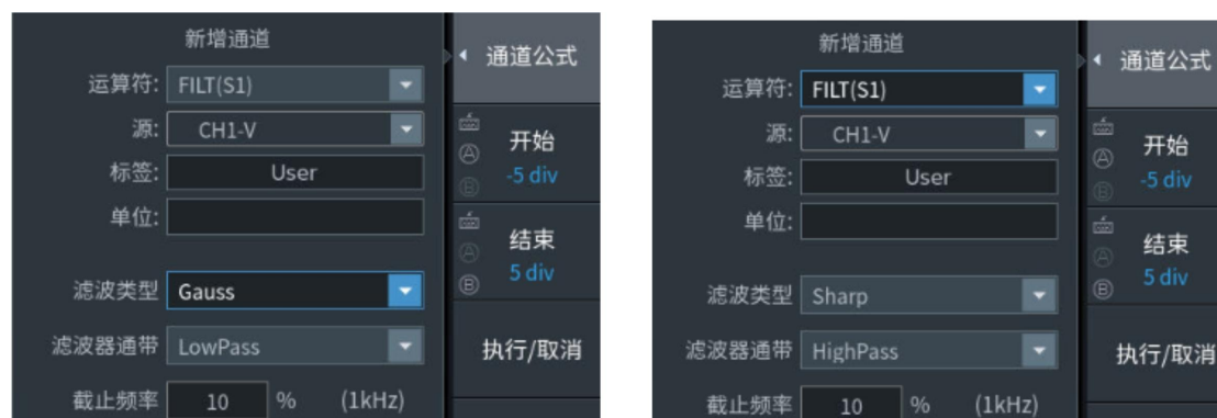
图 5.12 滤波器通带 LowPass 和 HighPass 截止频率设置
