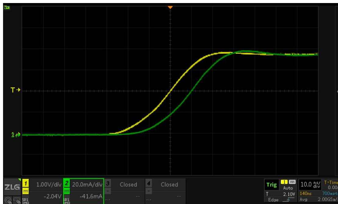
图 3.6 调节水平旋钮后的“SMALL LOOP 电压”和“SMALL LOOP 电流”波形
