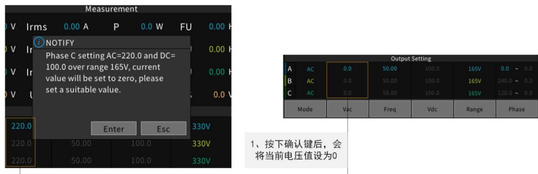
图 5.9 H 档向 L 档切换电压超限时设置
