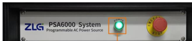
POWER按钮开关 绿色指示灯点亮
