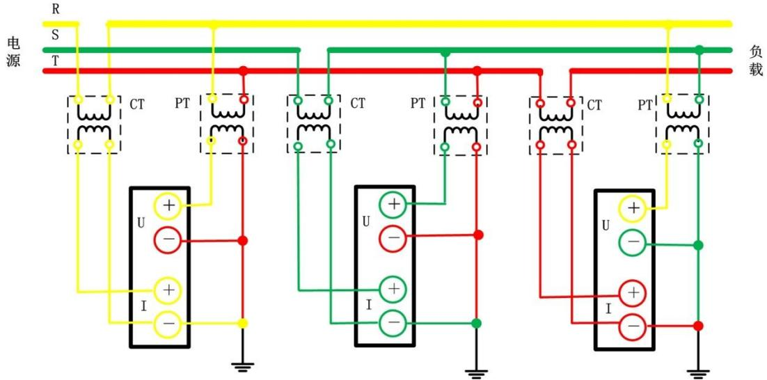
图 6.57 三相 3 线制(3 电压 3 电流表法), 使用 PT/CT 的接线
