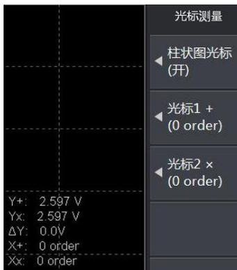
图 19.7 柱状图光标测量菜单
