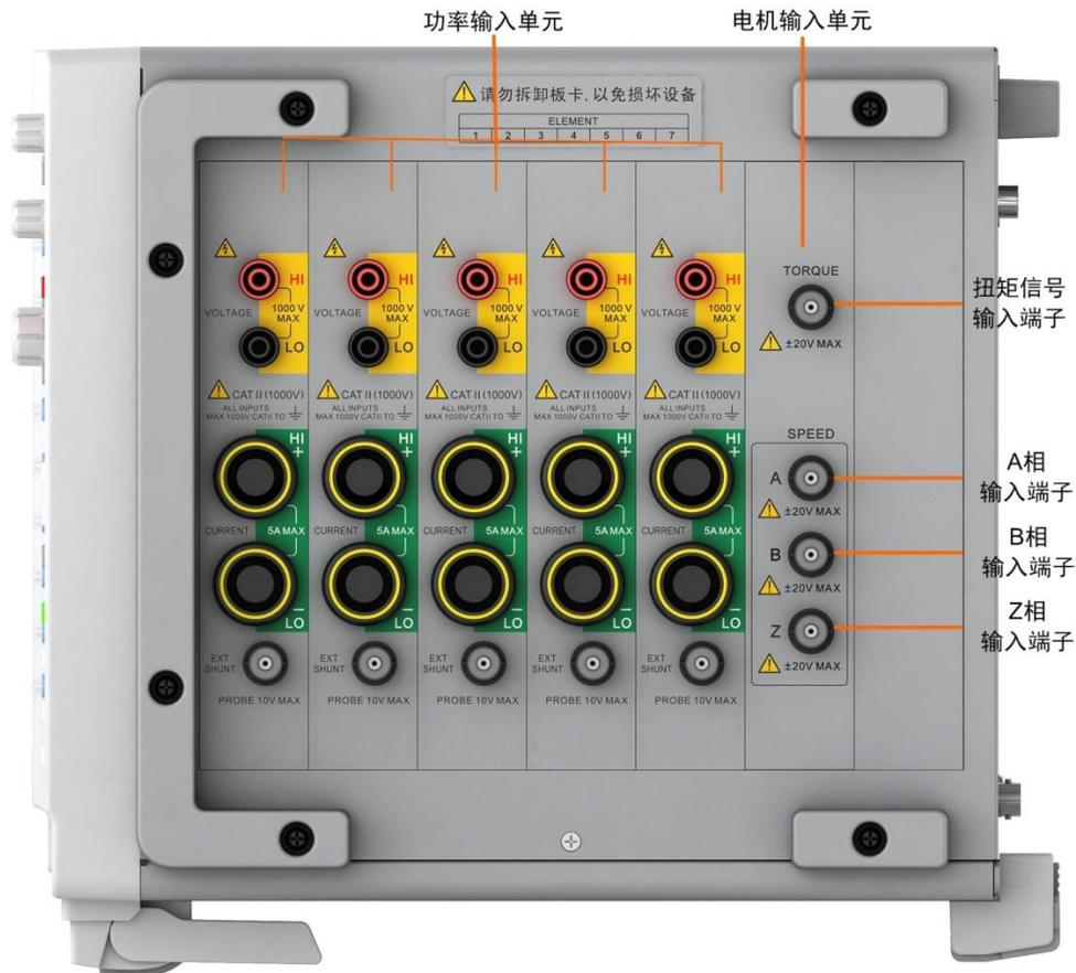
图 4.20 电机信号输入
