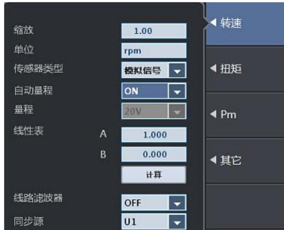
图 21.3 转速传感器信号模拟信号自动量程配置
