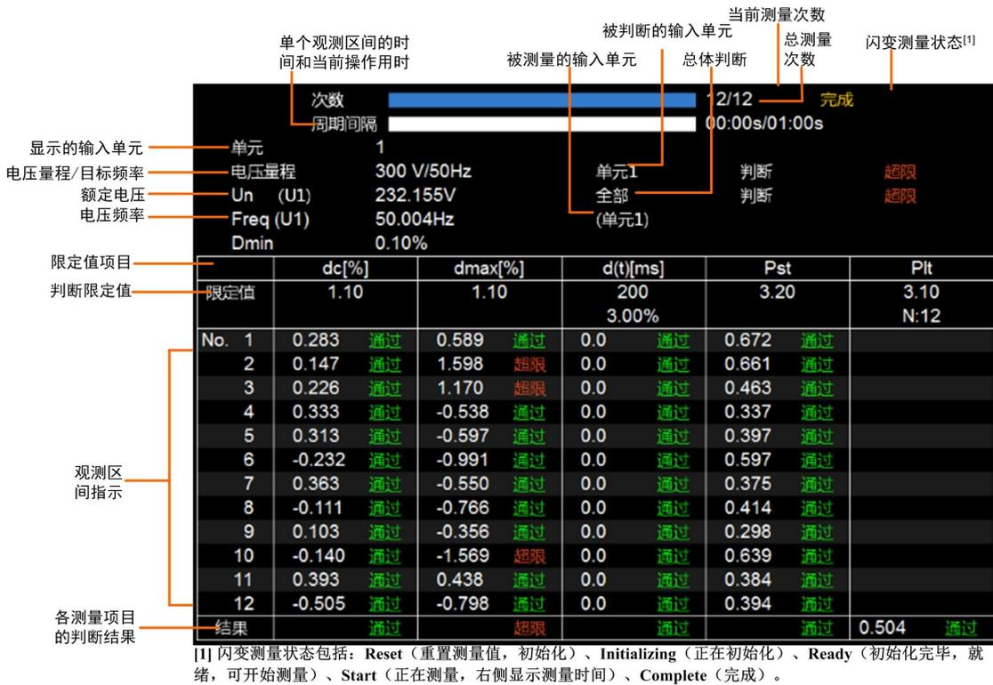
图 20.1 常规闪变测量结果
