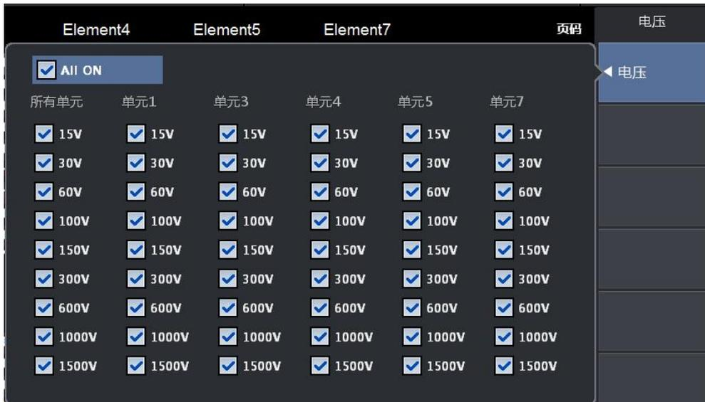
图 5.11 PA8000/PA6000H 电压量程范围配置
