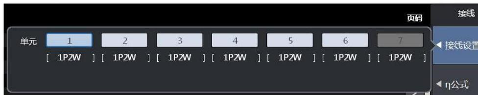
图 6.4 输入单元接线方式选择菜单
