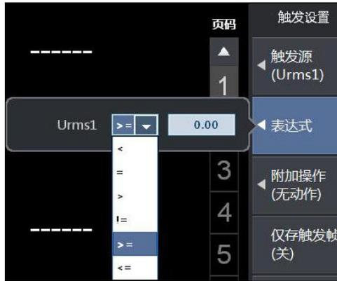
图 22.8 常规数据触发类型下的触发条件
