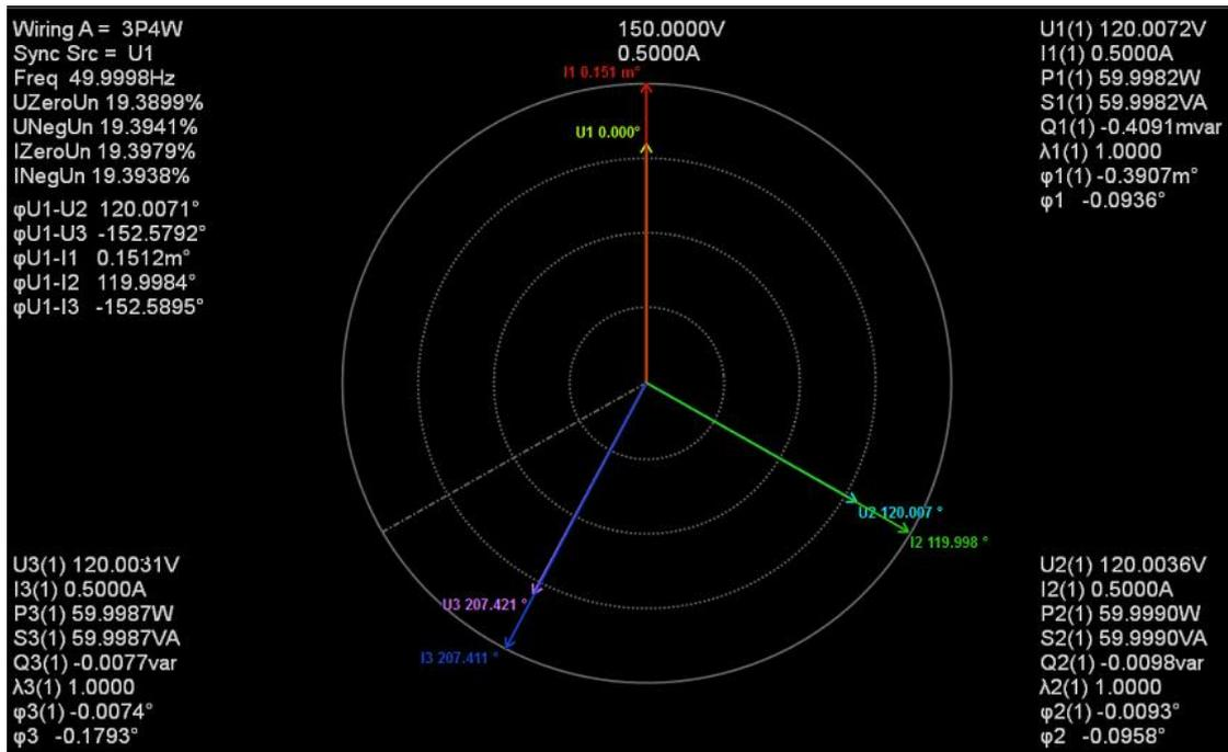
图 16.1 三相四线制接线组向量显示示例
