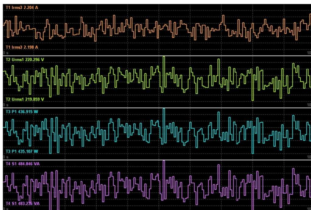
图 4.8 多个测量项目趋势分析图
