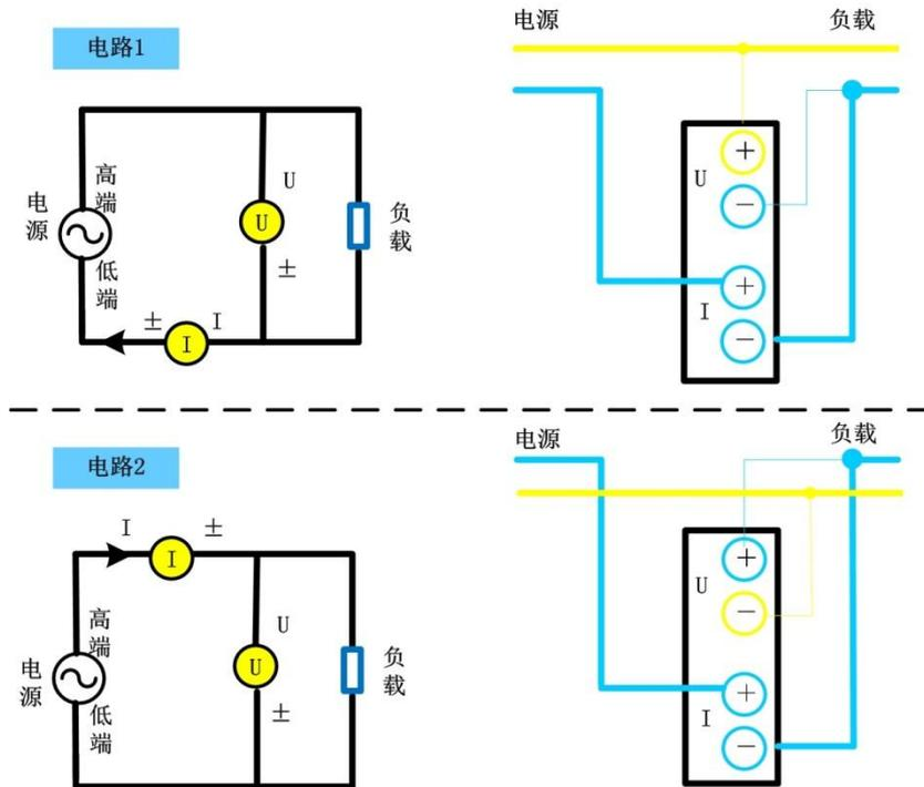
图 6.47 单相 2 线制(1P2W)，测量仪表的接线
