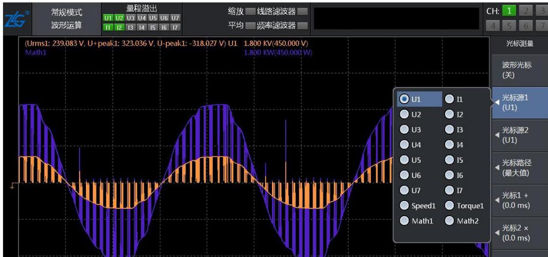
图 19.5 波形运算界面下可执行光标测量的波形
