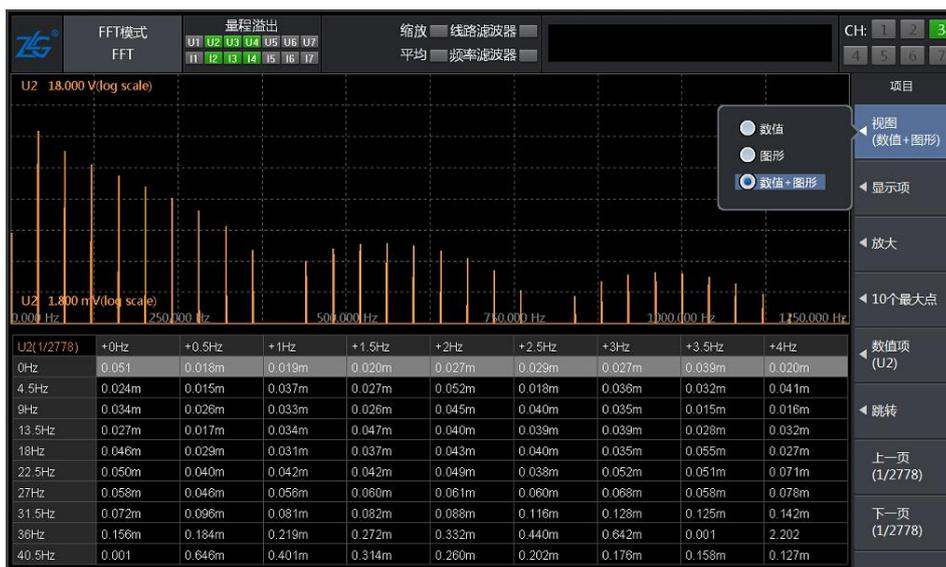
图 11.4 FFT 视图显示格式
