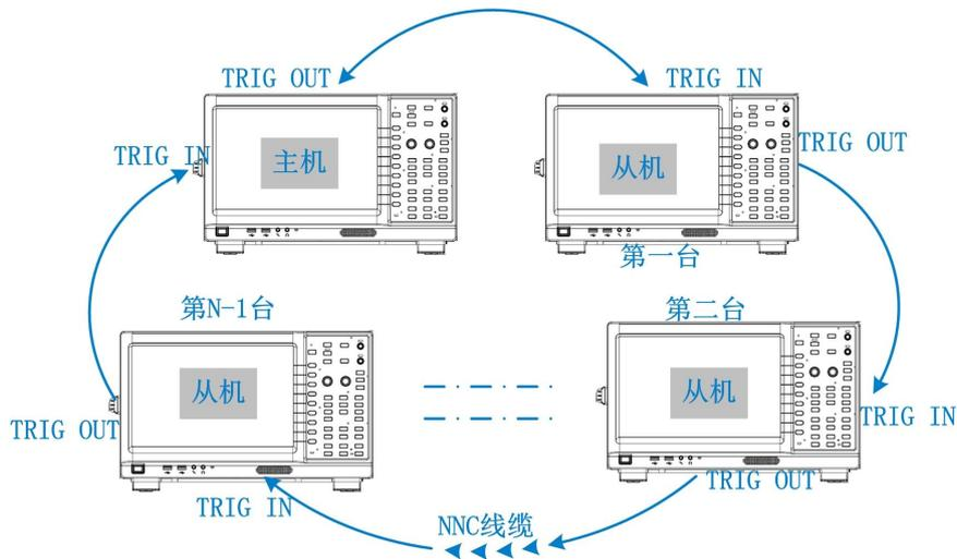
图 6.36 多台仪器级联示意图
