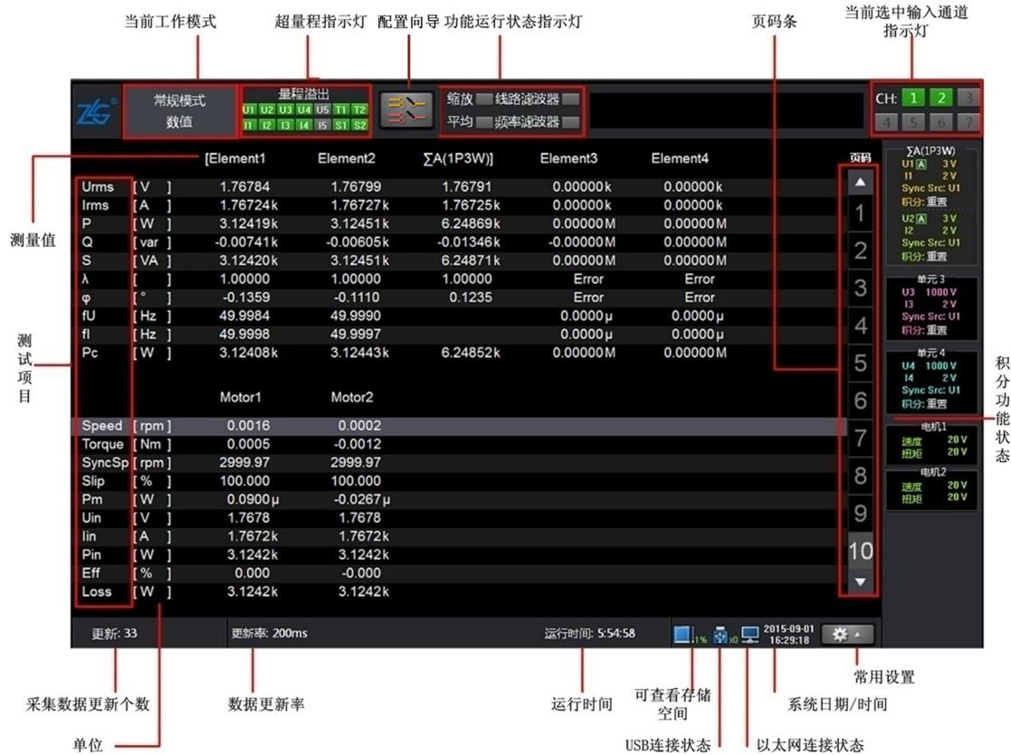
图 5.2 常规测量模式下的屏幕显示
