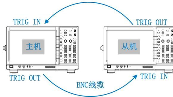
图 6.35 两台机器级联示意图
