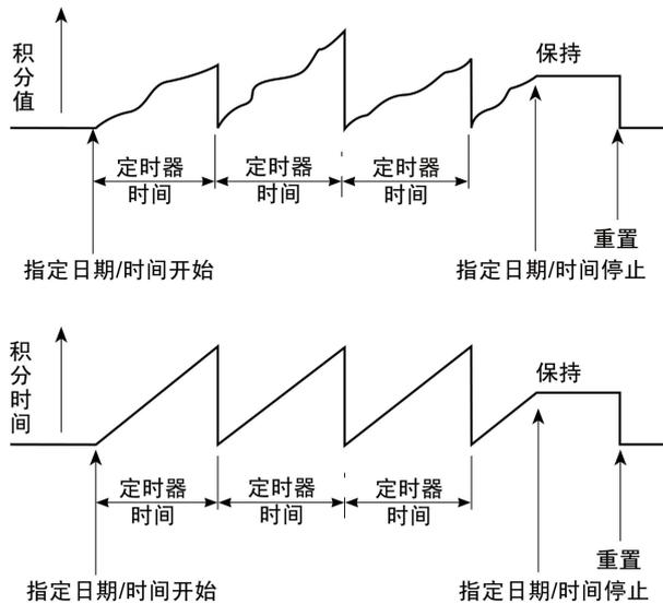
图 14.19 实时循环积分模式示意
