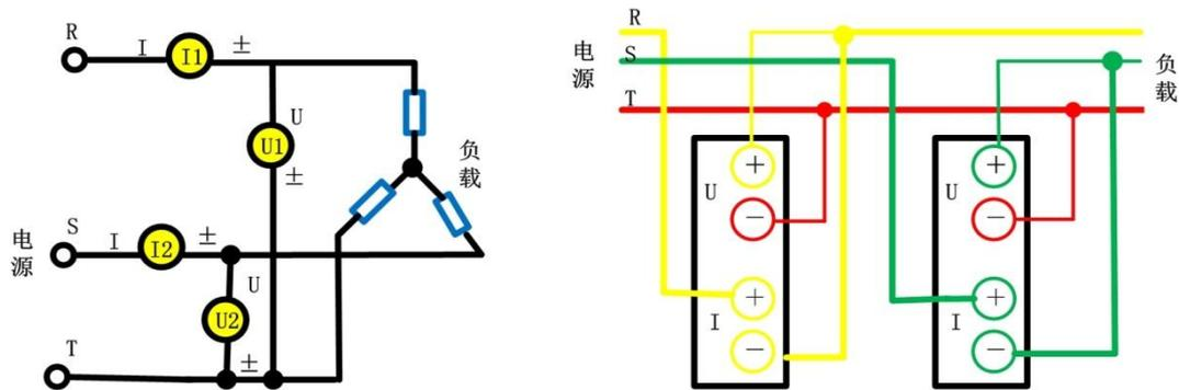
图 6.53 三相 3 线制、测量仪表的接线
