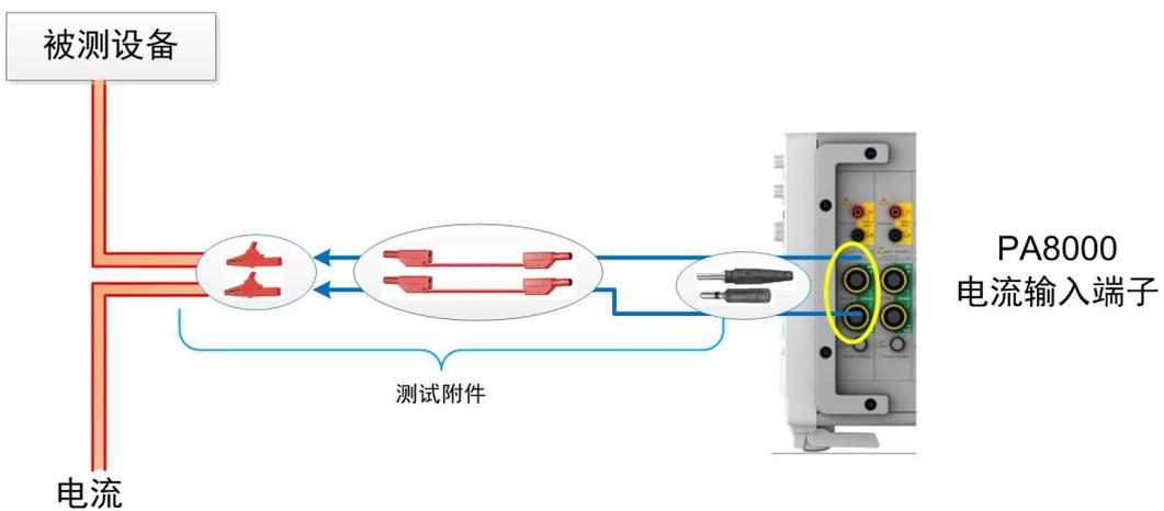
图 6.63 使用电流输入端子直接测量电流
