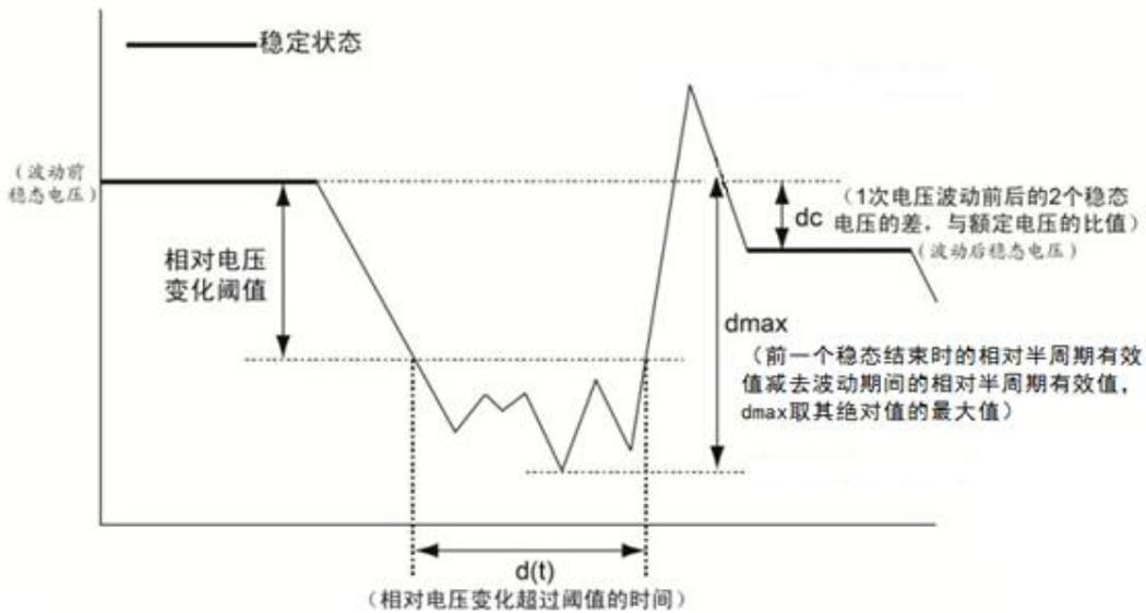
图 20.25 dc、dmax、d(t)之间的关系
