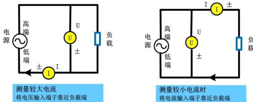
图 6.46 测量电压和电流的大小对测量的影响
