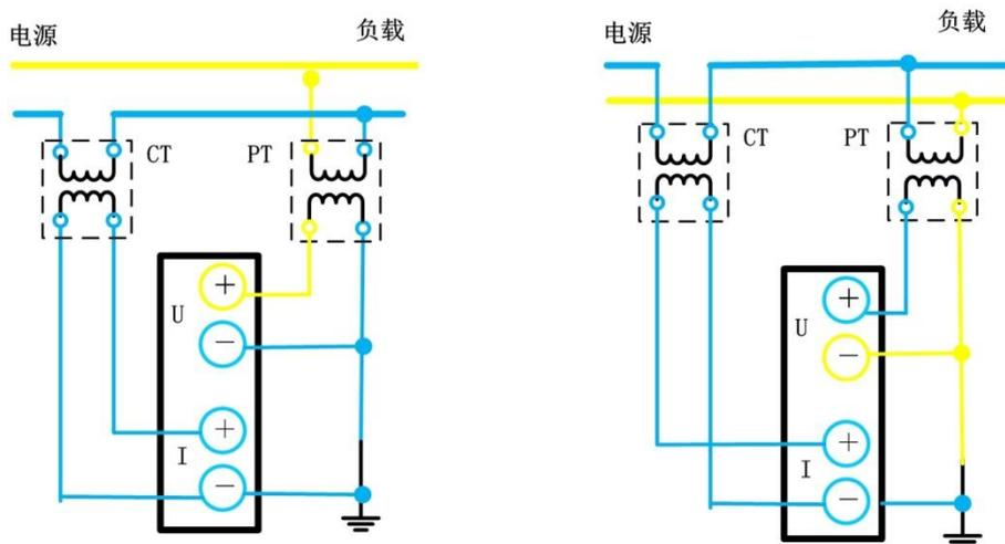
图 6.48 单相 2 线制 (1P2W)，使用 PT/CT 时的接线举例
