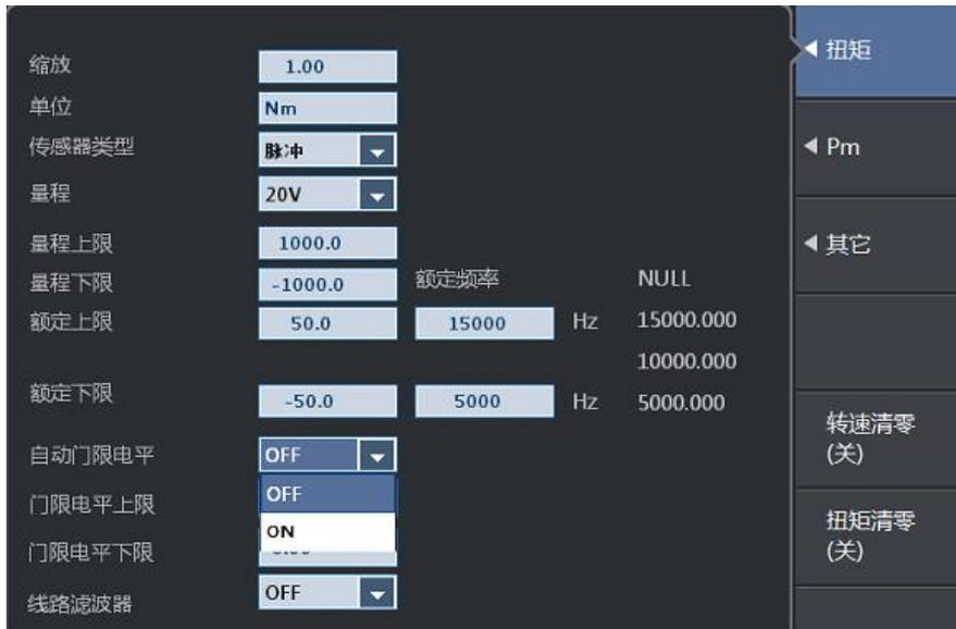
图 21.11 扭矩信号的自动门限配置
