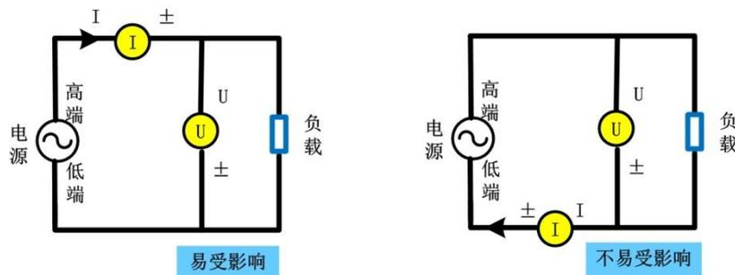
图 6.45 降低杂散电容对测量精度的影响
