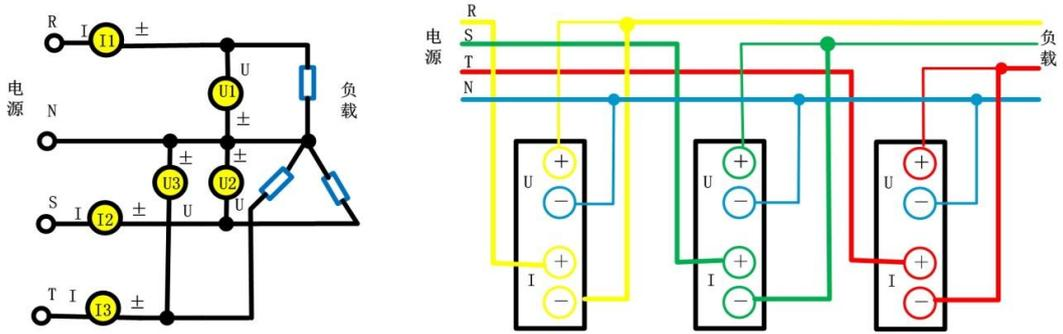
图 6.59 三相 4 线制下的测量仪表接线
