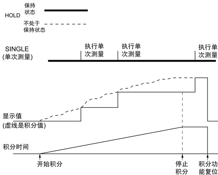
图 14.21 按下单次测量键后的积分显示
