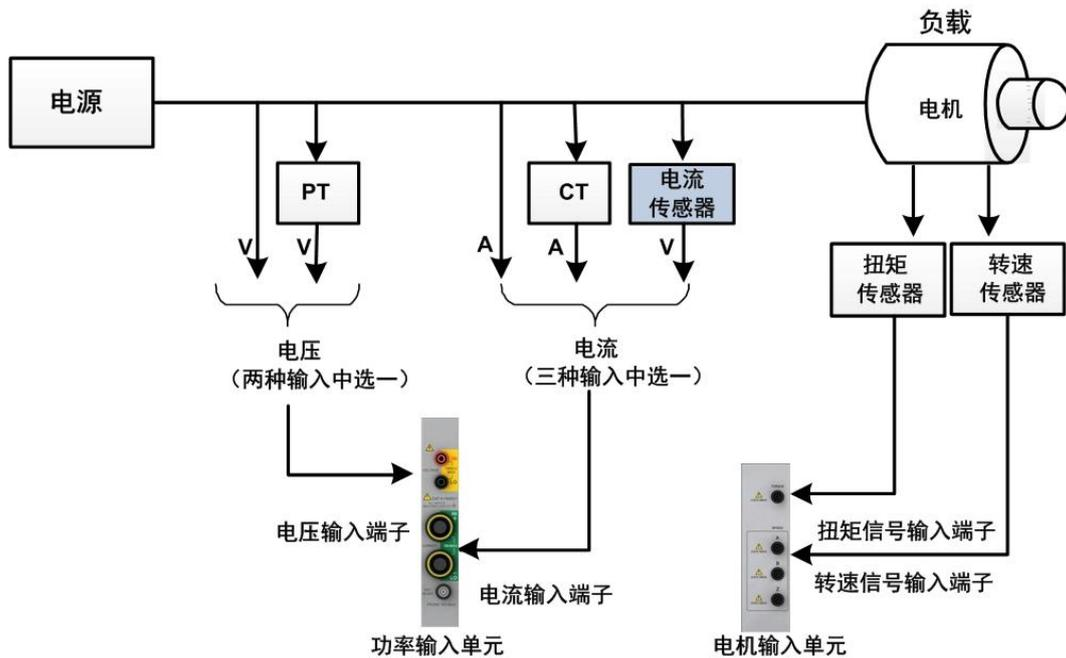
图 4.21 输入信号到输入单元
