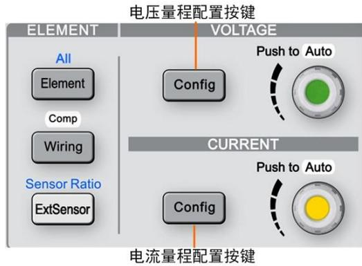
图 5.10 电压/电流量程配置按键
