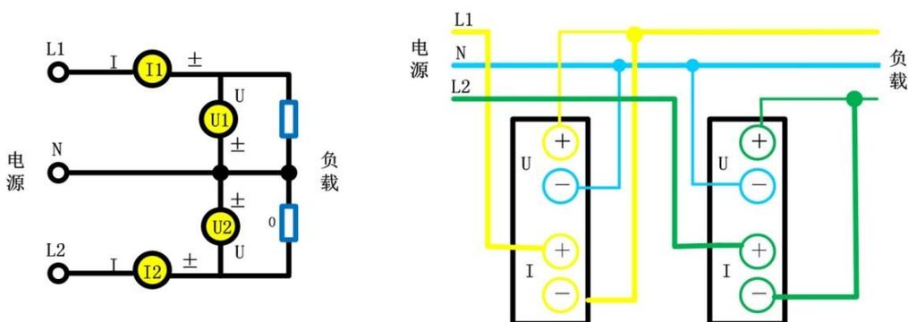
图 6.50 单相 3 线制 (1P3W)，测量仪表的接线
