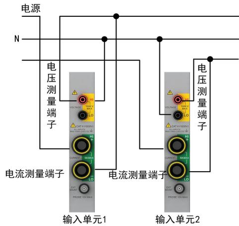
图 6.52 1P3W 下功率分析仪接线实例
