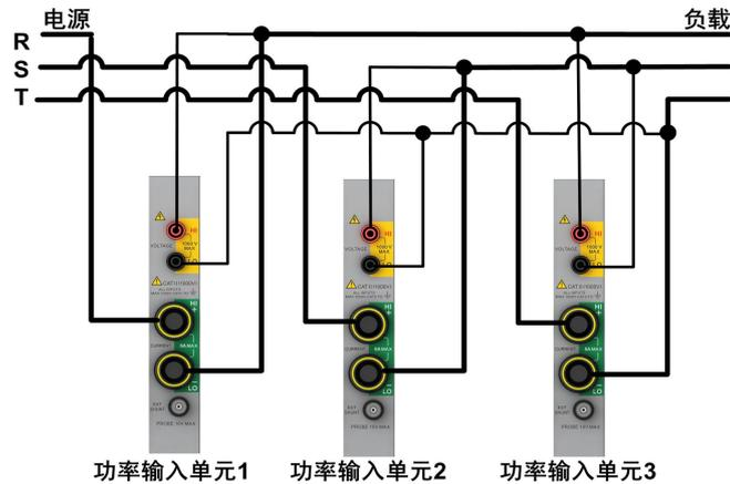
图 6.58 3P3W(3 电压 3 电流表法)下功率分析仪接线示例
