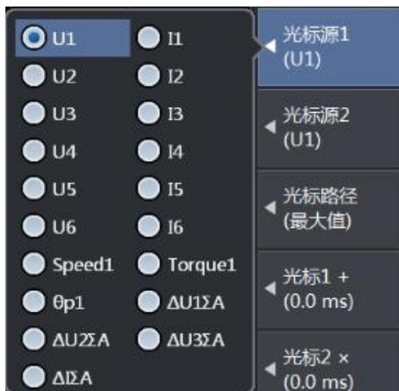
图 19.3 波形显示界面下可测量的波形
