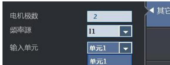
图 21.19 选择用于测量电机的输入单元
