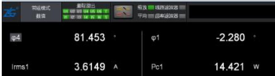
图 7.8 相位差测量结果显示
