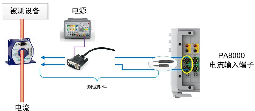
图 6.64 使用电流传感器 (CT) 和电流输入端子测量电流
