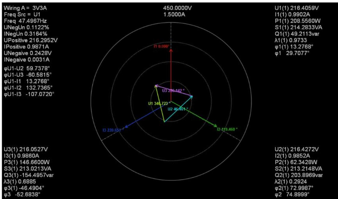
图 16.4 3P3W(3V3A) 向量显示示例
