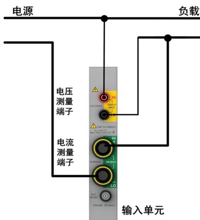
图 6.49 1P2W 下功率分析仪接线实例
