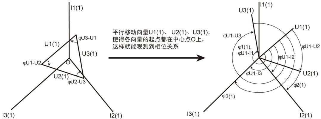
图 16.5 3P3W (3V3A) 向量显示示例
