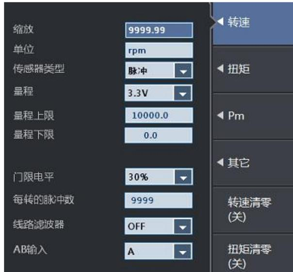
图 21.7 转速输入量程
