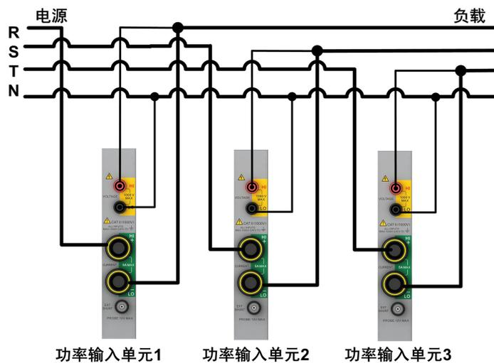
图 6.61 三相 4 线制接线实例
