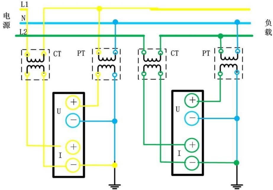
图 6.51 单相 3 线制 (1P3W)、使用 PT/CT 时的接线举例
