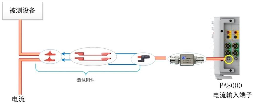
图 6.65 使用分流型传感器输入端子测量电流
