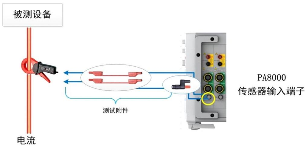
图 6.66 使用电压输出型传感器输入端子测量电流
