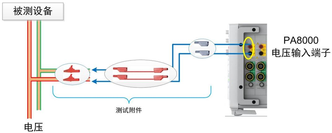
图 6.62 使用电压输入端子直接测量电压
