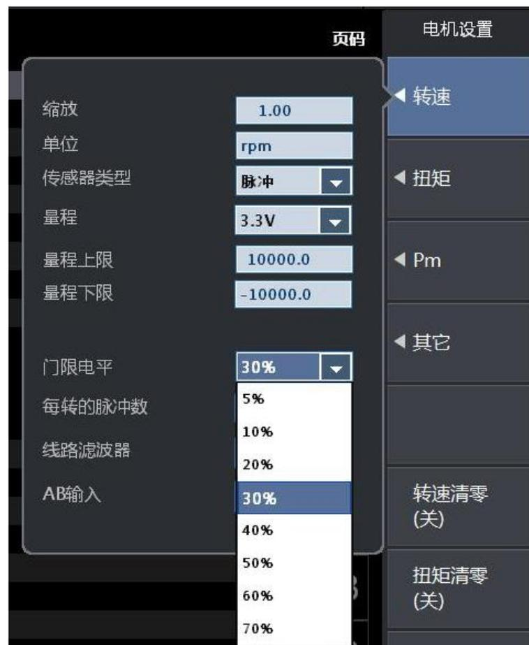
图 21.13 转速信号的手动门限配置
