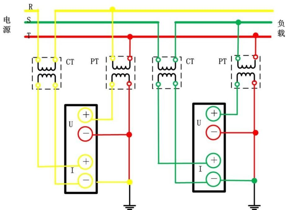
图 6.54 三相 3 线制 (3P3W)、使用 PT/CT 时的接线举例
