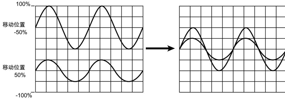
图 8.10 波形垂直移动示例
