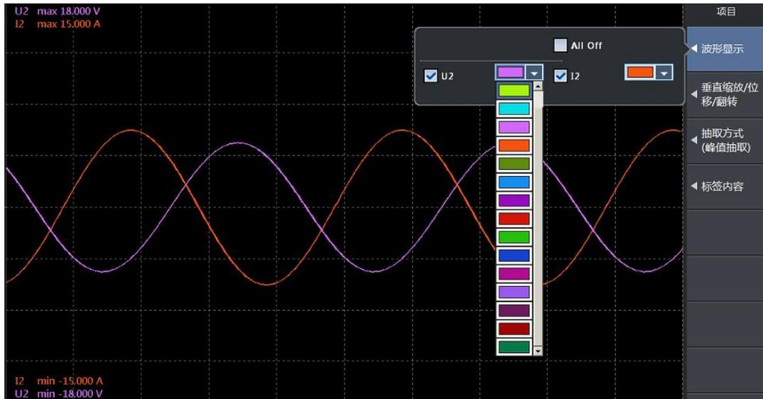
图 8.6 显示波形颜色设置
