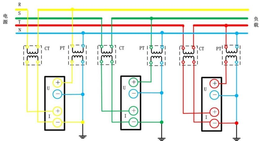
图 6.60 三相 4 线制 (3P4W)、使用 PT/CT 时的接线举例
