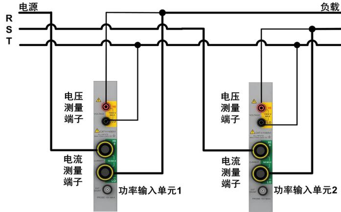
图 6.55 3P3W 下功率分析仪接线示例
