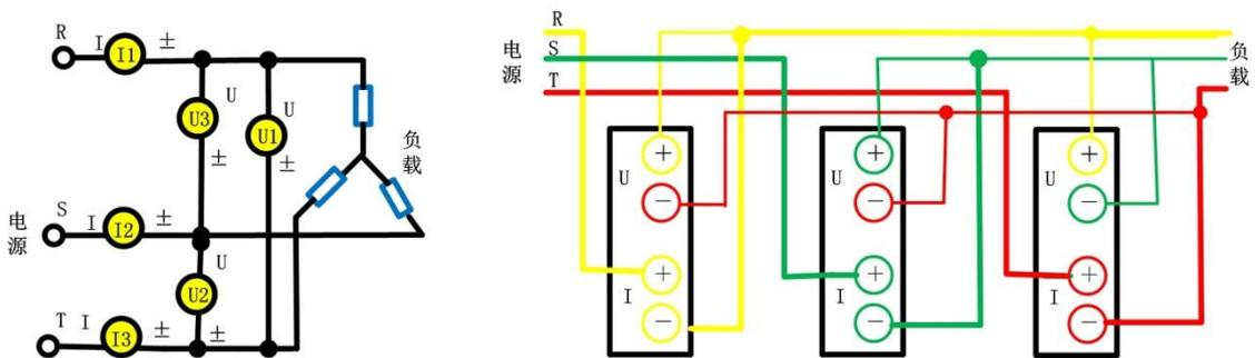
图 6.56 三相 3 线制(3 电压 3 电流表法)，测量仪表接线
